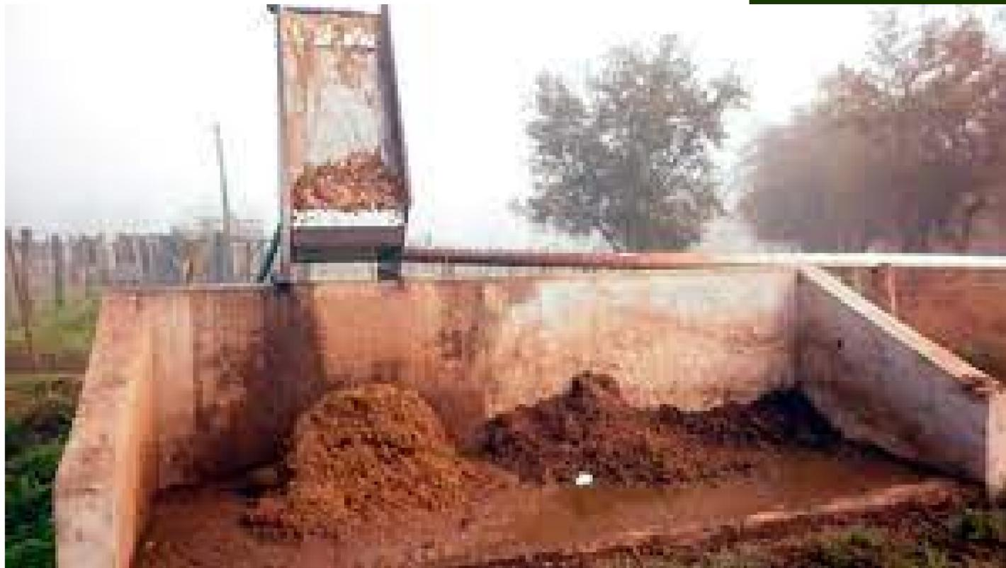
La separación de sólidos de los subproductos de tambo por acción física y/o mecánica, genera la concentración de nutrientes y MO en la fracción sólida. La menor carga orgánica en el efluente líquido remanente, garantiza una mayor eficiencia del sistema de tratamiento secundario previo a su disposición final.
