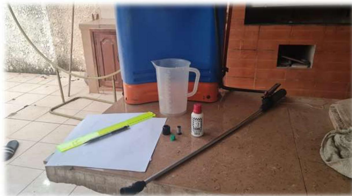
*Nota.* Se improviso con las hojas de papel bond y el colorante para dar una coloración roja a las gotas y así poder evaluar tamaño y uniformidad. No se contó con tarjeta hidro sensible.
