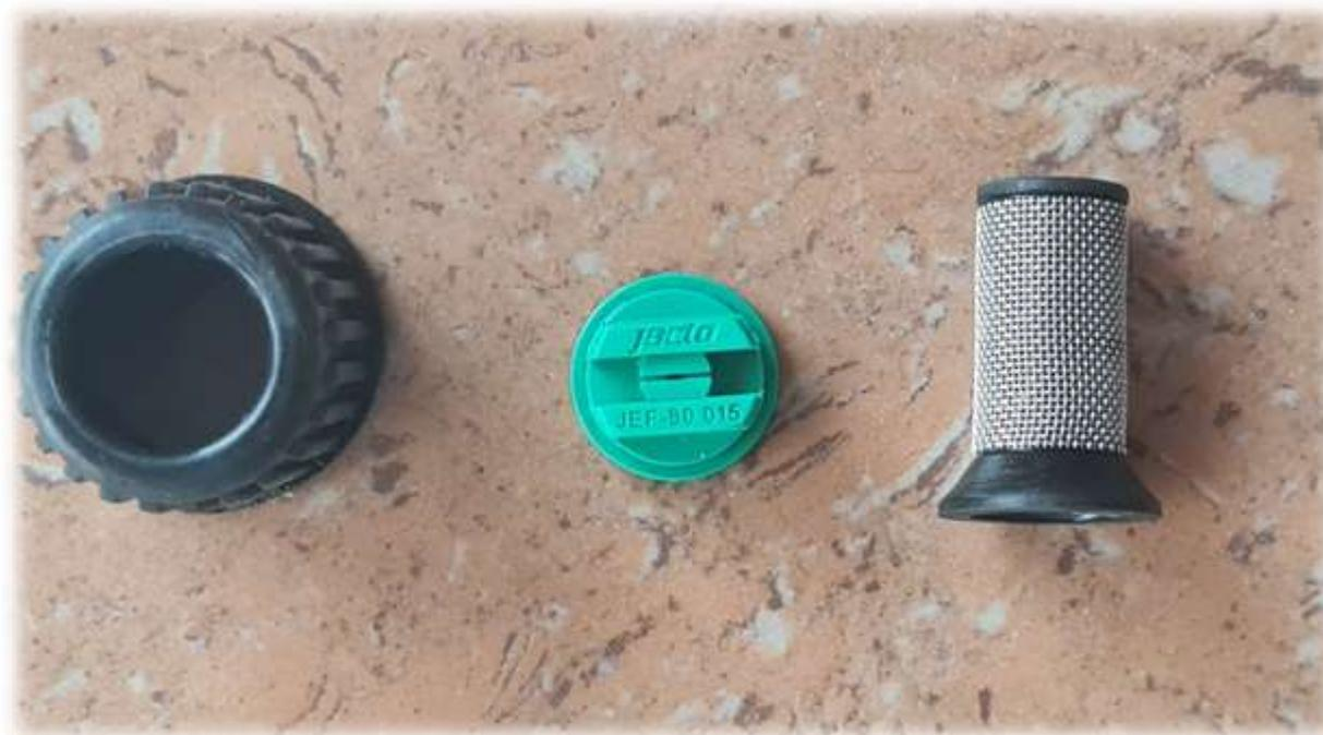
*Nota.* Las características de la boquilla y el filtro son las siguientes: Tipo de boquilla abanico plano uniforme, ángulo de aplicación 80°, material de fabricación plástico, identificación por caudal por el color (NORMA ISO) y escala de presión 30 a 60 psi; Filtro malla 50 – Alta presión.
